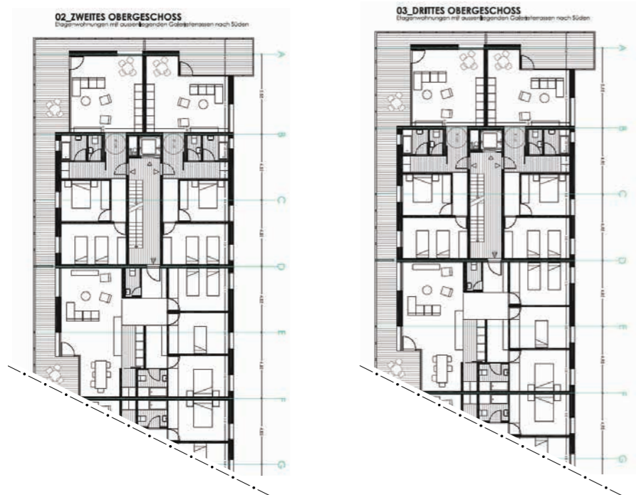
Plans des appartements des étages 2 et 3
